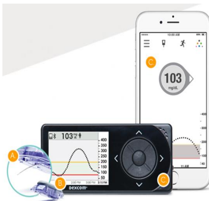
Рис. 26. Элементы системы НМГ: А – сенсор; В – передающее устройство; С – монитор или смартфон
