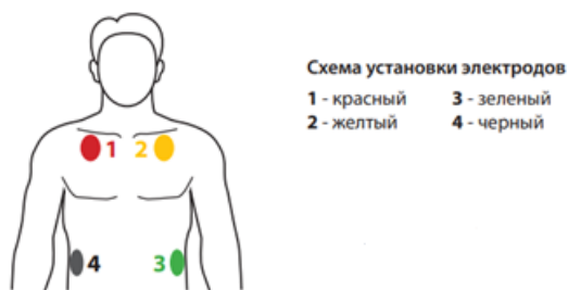
Рис. 2. Схема расположения электродов ECG Dongle
