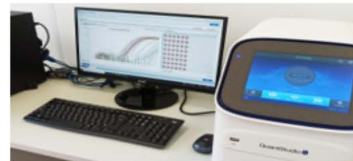
Амплификатор нуклеиновых кислот Applied Biosystems Quant Studio 5 с гибридационно-флуоресцентной детекцией продуктов ПЦР в режиме реального времени
